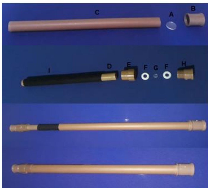
Figura 2 - Identificação dos materiais utilizados na montagem da luneta astronômica
